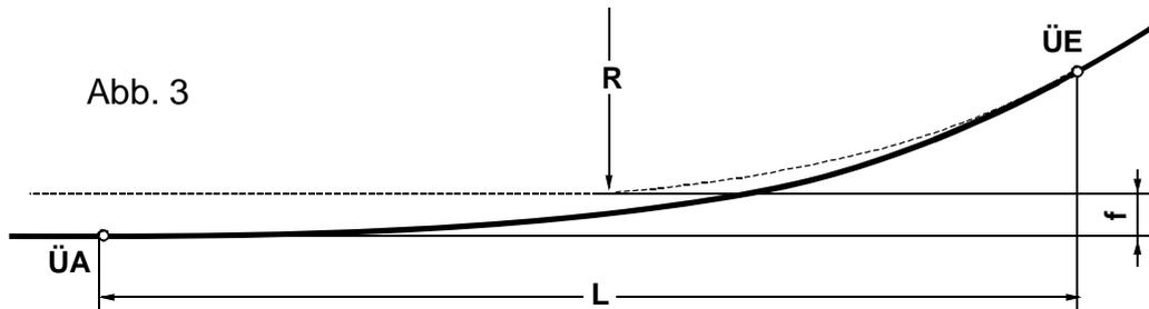
Um die zu einem bestimmten Kreisbogen mit dem Radius  $R$  passende Kombination der Werte  $L$  und  $f$  zu bestimmen, werden zwei Methoden zur Wahl gestellt:
