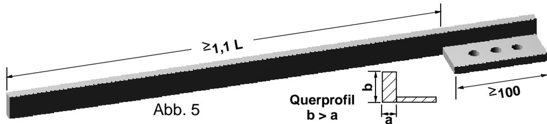
Am Punkt ÜE wird der Stab tangential an den Kreisbogen angelegt und die Platte wird in dieser Lage auf der Unterlage befestigt. Durch Biegen wird der Stab an den Punkt ÜA herangeführt und dient damit als Kurvenlineal zum Aufzeichnen des ÜB (Abb. 6).
